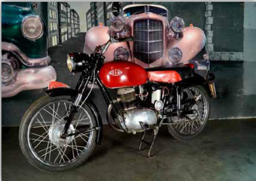
Moto da corsa, motore a due valvole, di un'altra epoca. Questo esemplare con forcella telescopica e motore a quattro tempi si trova in buono stato ed è subito marciante.
